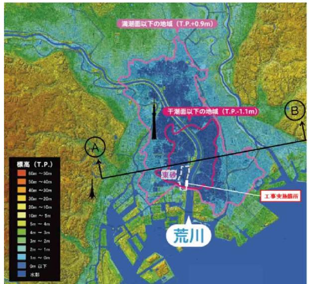
図-2. ゼロメートル地帯(地盤高平面図)
