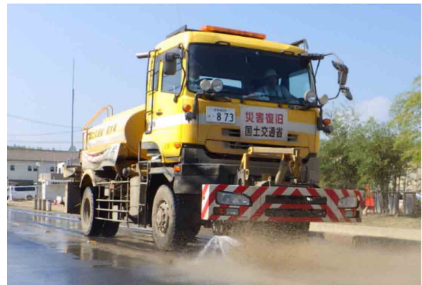
写真-10 散水車による防塵対策 (岡山県倉敷市)
