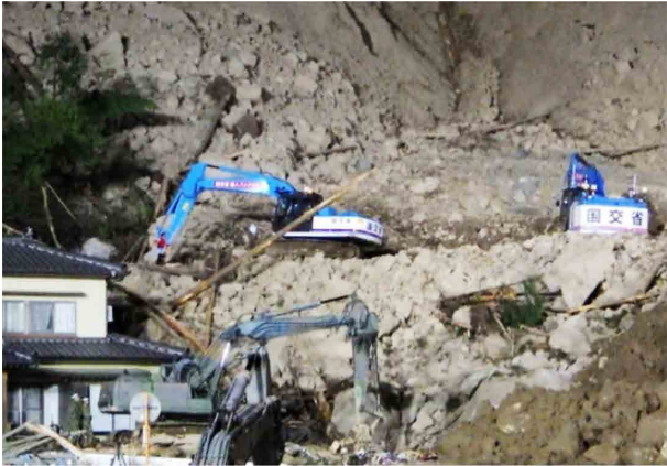
写真-3 遠隔操作式バックホウによる捜索支援活動状況 (大分県中津市)
