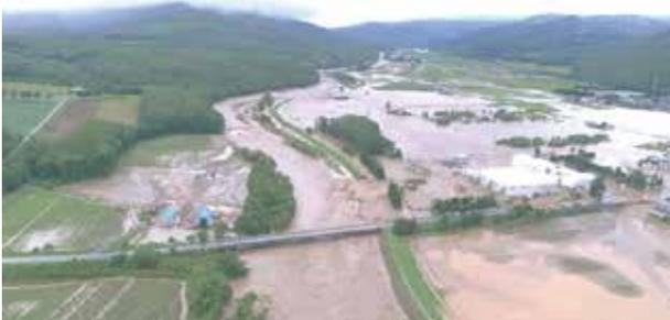
写真-3 堤防の決壊による氾濫状況(石狩川水系空知川)
