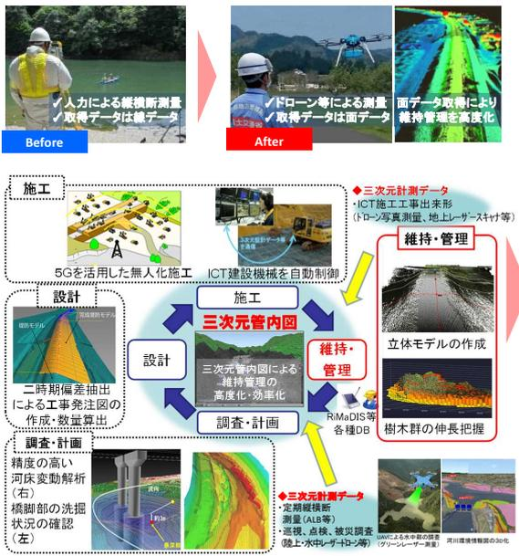
**Before** 人力による縦横断面測量 取得データは線データ
