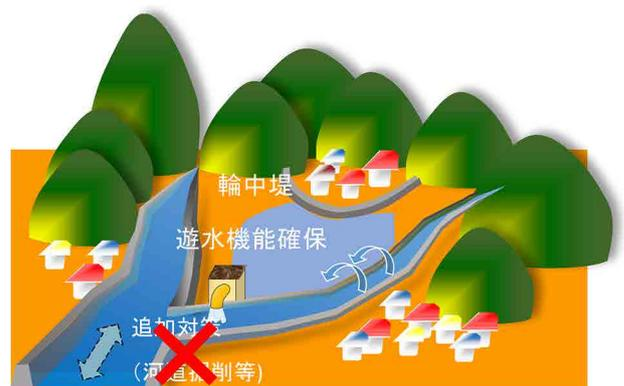
〈図-7〉 新たな再度災害防止対策のイメージ (流域治水型災害復旧制度)
