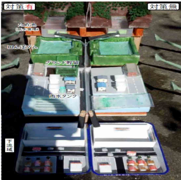
流域治水対策の効果を表現した模型 (鳥取大学・鳥取県による共同制作)
