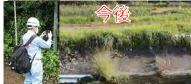
点群データの取得及び動画撮影 ⇒自動でクラウドソーバへアップされ、三次元データが作成される
