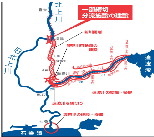
北上川第一期改修事業 (M44~S9)
