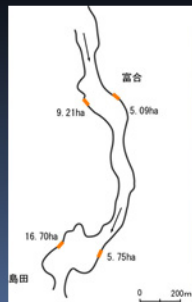
富合・島田の轡塘の形状と乗越堤の箇所
