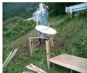
カメラ及びKu-SAT(小型画像伝送装置)による浸水状況の監視
