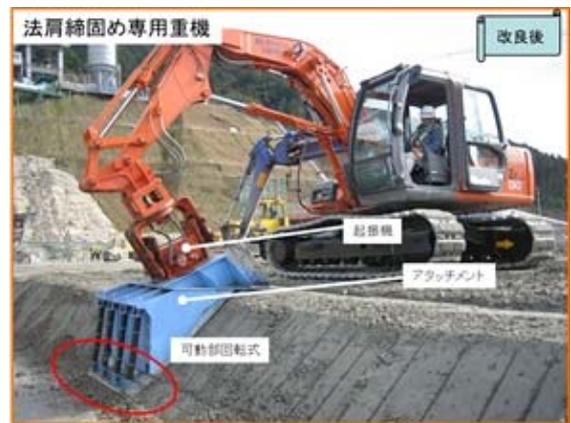
巡航 RCD 工法法肩締め固め機
