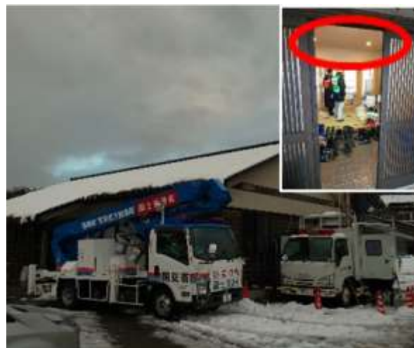
照明車を用いた避難所への電源支援
