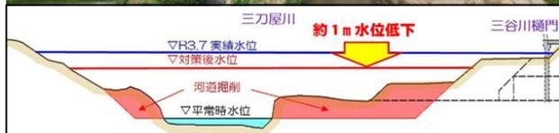
＜三刀屋川 推進費による河道掘削後＞
