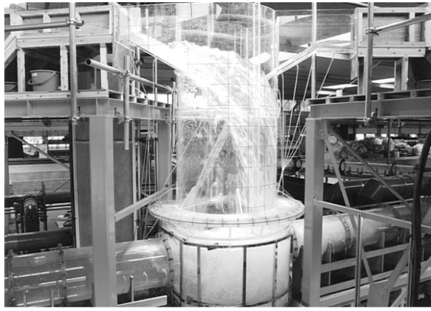
写真 4 第 3 立坑流入模型実験
