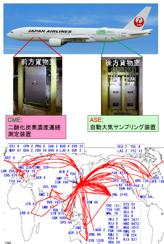
図 1.3.6 CONTRAIL プロジェクトで利用しているボーイング 777-200ER 型機と 2 つの観測装置 (上)、二酸化炭素観測を実施した飛行ルート及び飛行先の空港コードと鉛直分布観測回数 (下)
