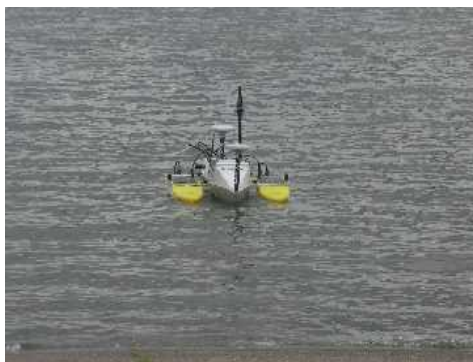
無人ボートによる堆砂測量
