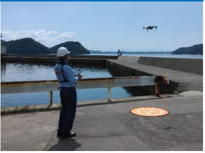
ドローンによる被災状況調査(熊本県天草市)
