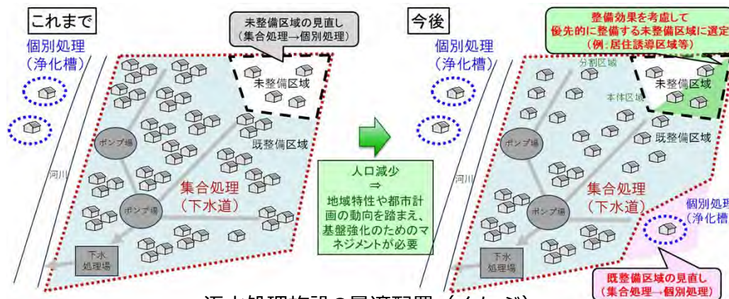
污水处理施設の最適配置 (イメージ)
