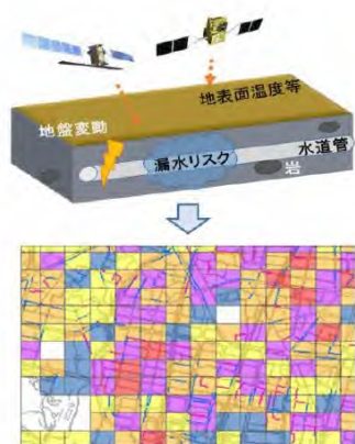
人工衛星画像を用いた漏水リスク評価
