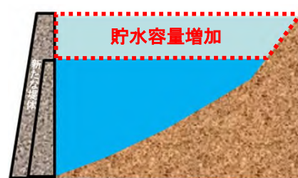
ダム再生の事例(堤体のかさ上げ)
